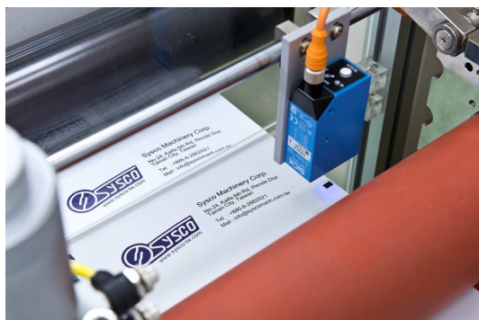
CONTROL POSICION MEDIANTE SENSOR
