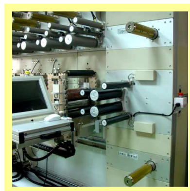
12. Rebobinadores principales de material conducidos por Servomotor.
