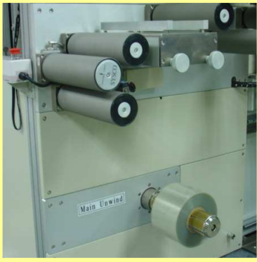
1. Desbobinador principal para material impresión inferior mediante servomotor y control de tensión
