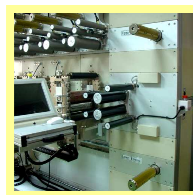
12. Rebobinadores principales de material conducidos por Servomotor.
